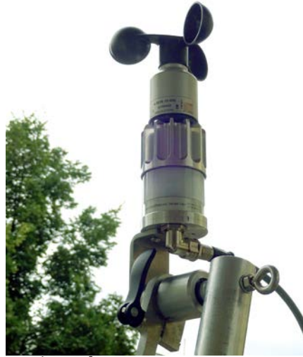
Hindernisfeuer mit integriertem Anemometer Obstacle light with integrated anemometer
